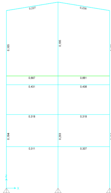
Figura B.1 Factores de utilización marco dirección XZ altura 0 m.
