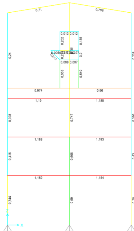
Figura B.19 Factores de utilización marco dirección XZ altura 17.3 m.
