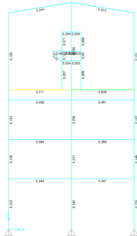
Figura B.4 Factores de utilización marco dirección XZ altura 17.3 m.
