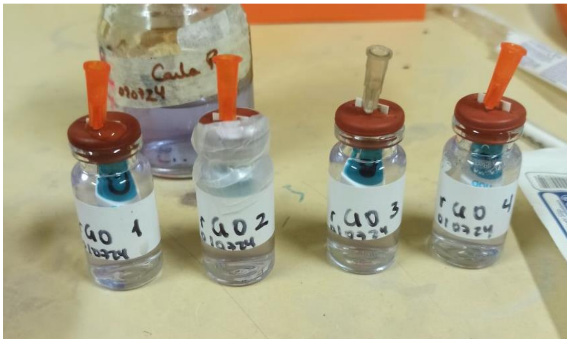
Figura 20. Montaje del ensayo sobre soportes para el análisis de voltamperometría cíclica. En la imagen se muestran los soportes de rGO, mientras que el ensayo con soportes de GO se llevó a cabo de manera análoga.
