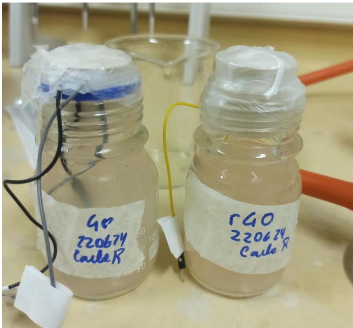
Figura 11. Montaje del ensayo sobre biopelículas para el análisis de viabilidad, proteínas, carbohidratos y ADN extracelular. Esta figura ilustra la configuración experimental utilizada para evaluar las diversas características de las biopelículas en los soportes GO y rGO.
