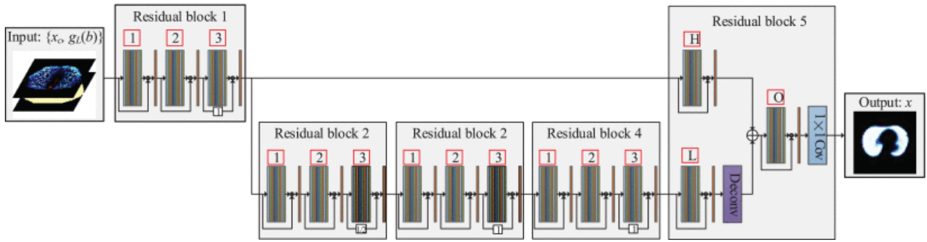
Fig. 3.20: Arquitectura propuesta con métodos de dos etapas. A partir de una imagen inicial, se refina esta con una CNN para llegar al resultado final [119].
