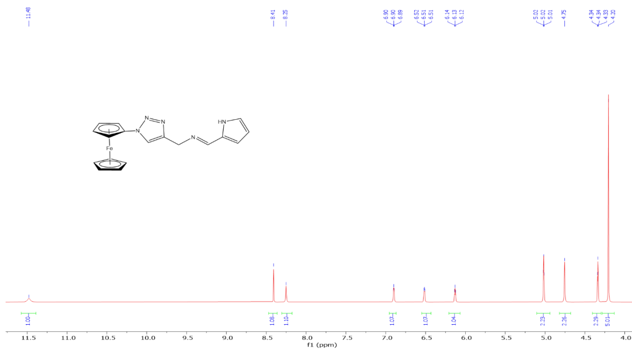
Fig. S21. Espectro 1 H NMR (400 MHz) del compuesto 4a en DMSO-d 6 .
