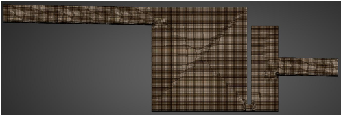
Figura 106: Mallado cajón de traspaso
