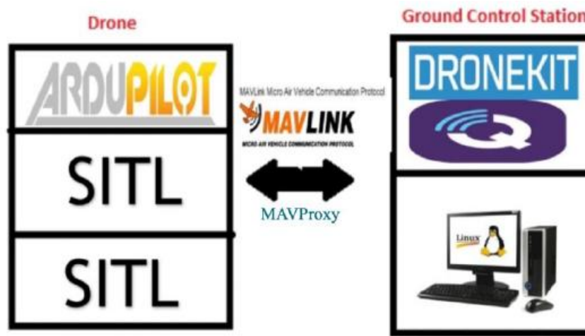
Figura 13: Diagrama de simulación SITL
