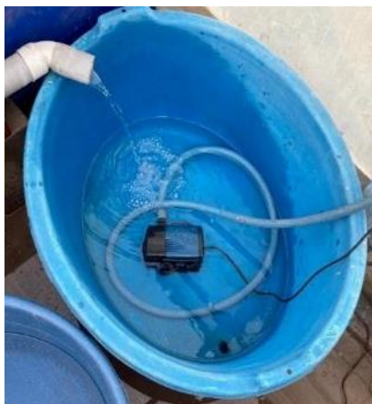
Figura 6. Tanque de reserva de agua con la bomba sumergible y desagüe de las camas hidropónicas.
