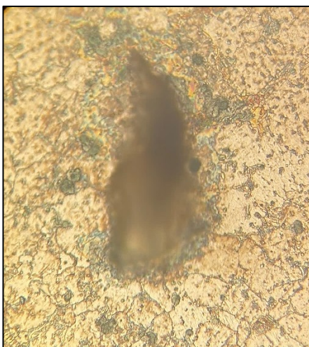
Figura 5.27 Poro y su vecindad en espuma M_{50, 1} , tratada termoquímicamente en N3.
