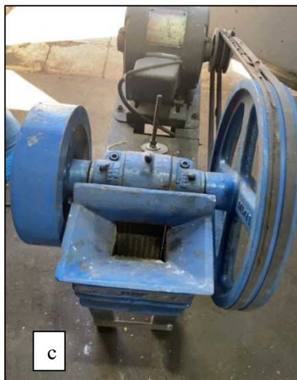
Figura 4.2 a) Tamizador de ensayos para polvos; b) Jarra con bolas de molienda; c) Chancador de mandíbula; d) Molino planetario.
