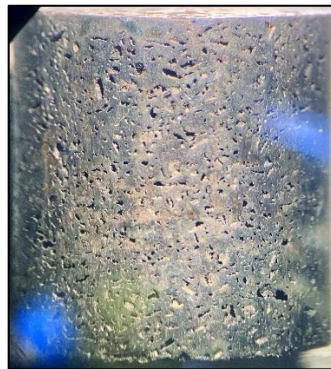
Figura 5.20 Espuma nitrurada con 70% de porosidad.
