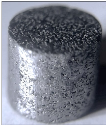
Figura 5.12 Espuma de Fe-5%Nb con 70% de porosidad.
