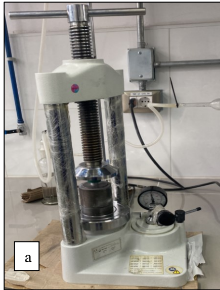
Figura 4.6 a) Montaje prensado uniaxial (prensa-matriz de compactación); b) Montaje prensado biaxial (prensa-matriz flotante-matriz de compactación).
