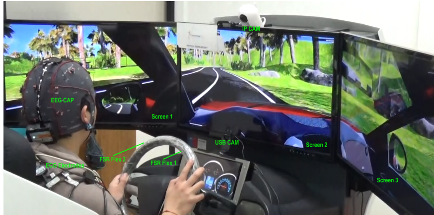
Figura 3.6: Se utilizó la cámara IP para monitorear el estado del participante y una cámara-USB para registrar el comportamiento facial de los voluntarios mientras conducían.
