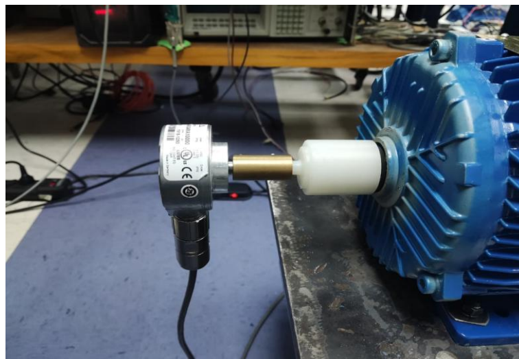
Fig. 4.3 Encoder incremental con acople de DUROCOTON ® y conector ensamblado
