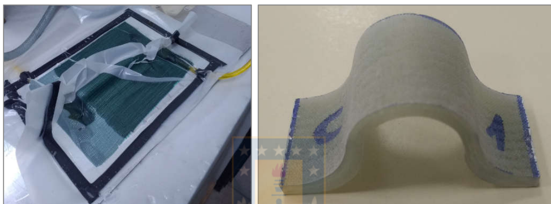
Figura 4-16. Proceso de fabricación de probetas para validación (izquierda); Probetas fabricadas para validación (derecha).
