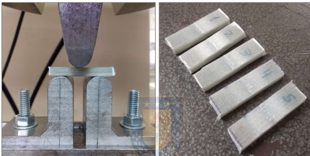
Figura 4-6. Configuración de ensayo (izquierda); Probetas ensayadas para determinación de ILSS (derecha).
