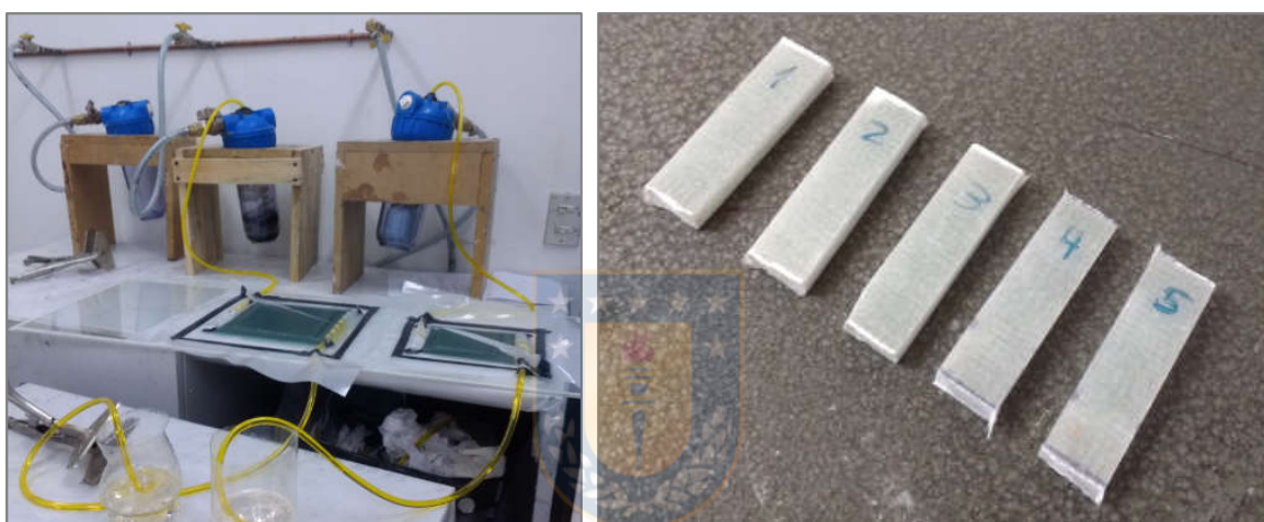
Figura 4-3. Proceso de fabricación de probetas (izquierda); Probetas fabricadas para determinación de ILSS (derecha).
