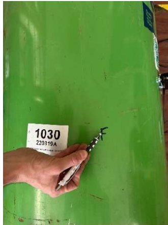
Figura 7: Ensayo de rotura de mina de lápiz
