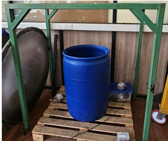
Figura 15: Estructura de vigas soldadas con sensores instalados y fuentes de EA marcadas.
