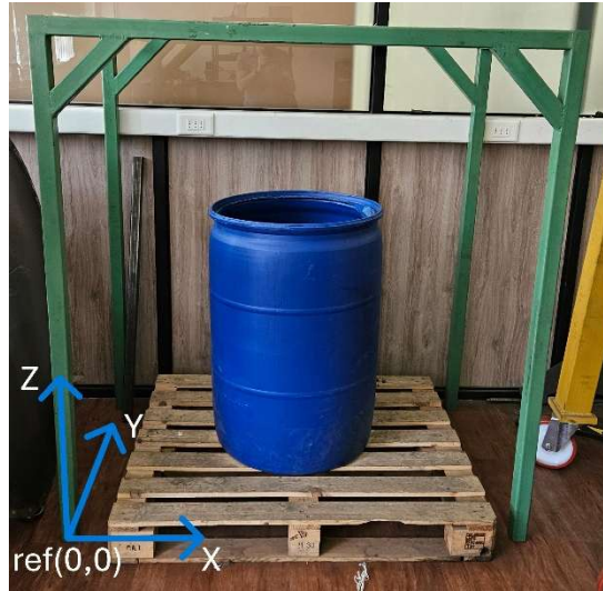
Figura 16: Estructura de vigas soldadas con ejes y referencia de origen del sistema de coordenadas
