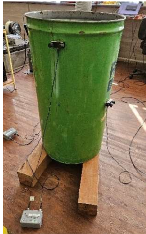
Figura 4: Tambor con sensores posicionados y amplificadores conectados
