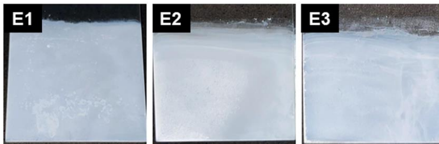
Figura 18. Imágenes de las muestras de BiOCl sintetizadas por SILAR: (E1) 30, (E2) 45 y (E3) 60 ciclos.
