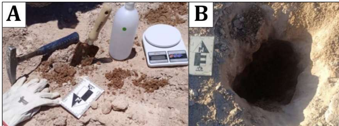
Figura 9. Proceso de recolección de muestras. A) Materiales utilizados para la extracción de muestras. B) Excavación realizada durante la extracción de una muestra.
