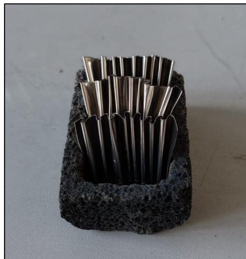
Figura 4.5 Láminas de Titanio corrugadas para maximizar su área superficial
