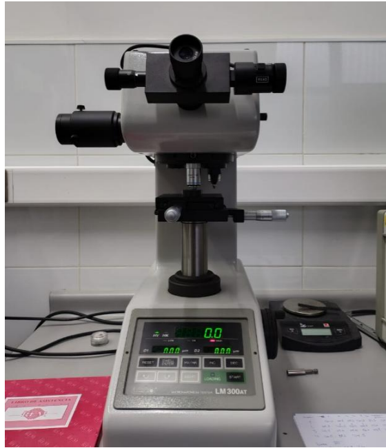
Figura 4.11 Microdurómetro utilizado para ensayos de Dureza HV_1 y Microdureza HV_{0.01} .
