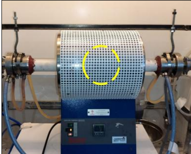
Figura 4.6 Posición referencial del centro del horno tubular donde se introducen las muestras.
