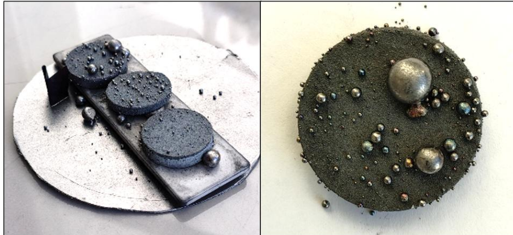
Figura 5.8 Muestras donde el hierro alcanzó fase líquida y sufrió esferoidización.
