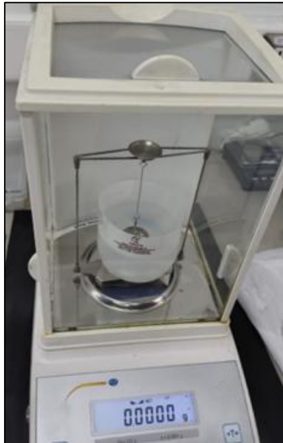
Figura 4.8 Montaje del ensayo de Arquímedes en balanza PCE-ABE220C
