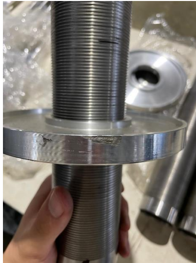
Figura 4.1.2: Grieta en soporte resorte inferior.
