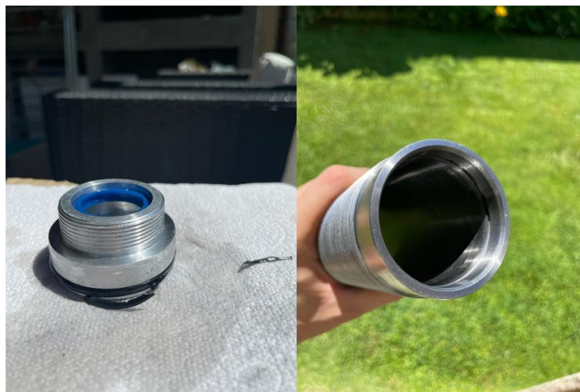
Figura 4.3.1: a) O-ring tapa superior mordido. b) Restos de o-ring en alojamiento.
