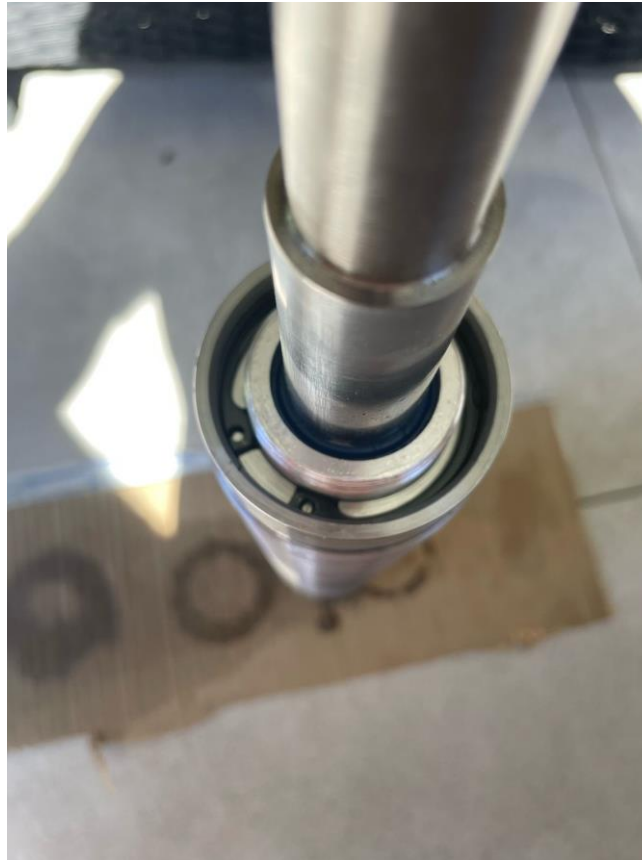
Figura 4.2.1.13: Perno tapa superior y seguro Seeger instalados.
