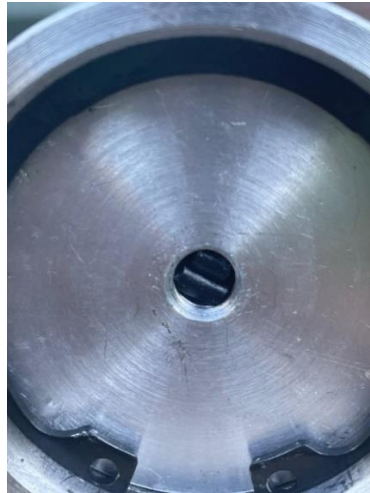
Figura 4.3.3: Fragmentos de o-ring en agujero tapa inferior.
