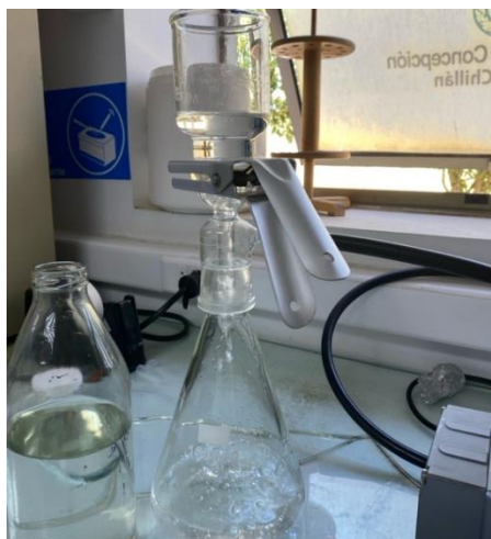
Figura 6. Equipo filtrador por membranas.
