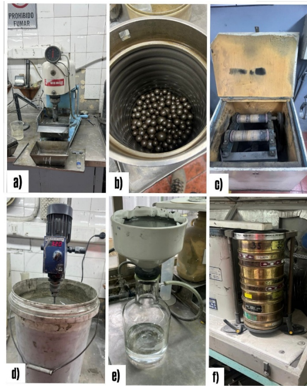
Figura 10. a) Celda de flotación Wemco; b) Molino de bolas; c) Rotor para molino; d) Agitador para homogeneización; e) Filtro de pulpa; f) Ro-Tap para análisis granulométrico.
