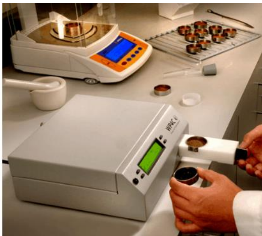
Figura 19. Método de presión de vapor (equipo WP4C).
