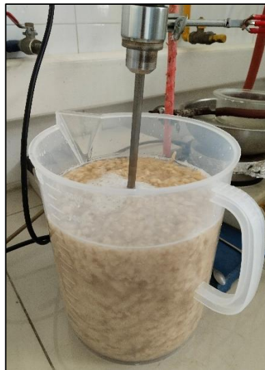
Figura 21. Pulpa disgregada en agitador eléctrico.
