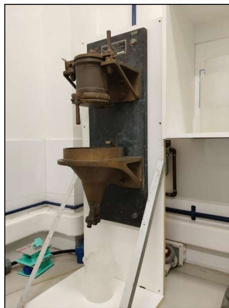
Figura 27. Equipo para análisis Canadian Standard Freeness.
