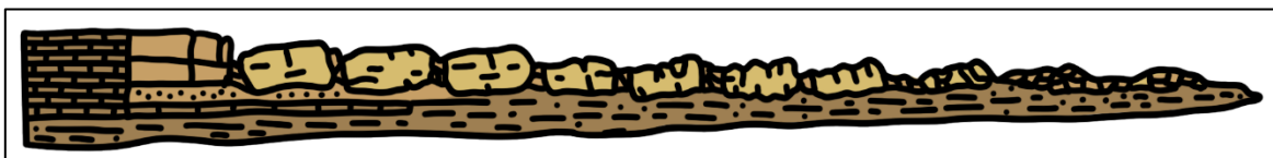
Figura 2.6.: Esquema de propagación lateral o lateral spread . Tomado y modificado de Cruden y Varnes (1996)
