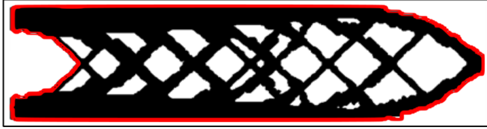
Figura 4.4 Identificación de elementos de contorno (rojo) en ejemplo de implementación computacional.
