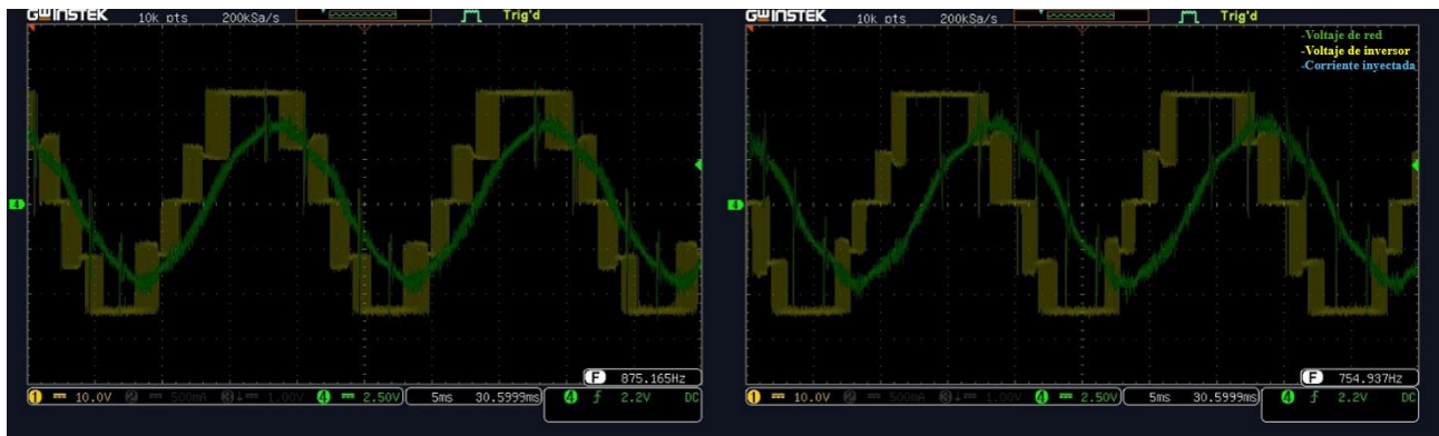
Figura 49 Voltaje de red e inductor con I_q=0 / Voltaje de red e inductor con I_q>0
