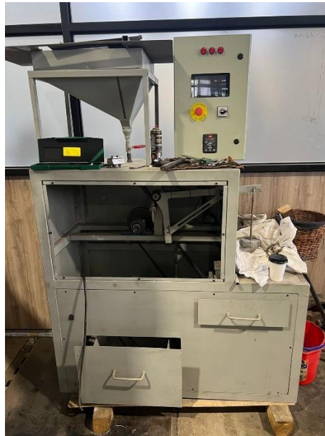
Figura 4: Máquina de desgaste abrasivo según norma ASTM G65.
