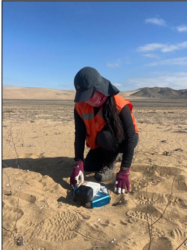
Figura 15: Instalación de Geode
