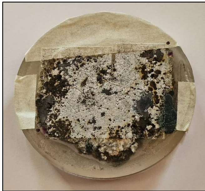
Figura 29. Muestra analizada mediante LIBS. Imagen de la muestra de estudio, luego del análisis completo mediante LIBS
