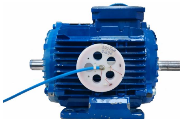
Fig. 4-4 Sensor de flujo disperso en posición radial-axial
