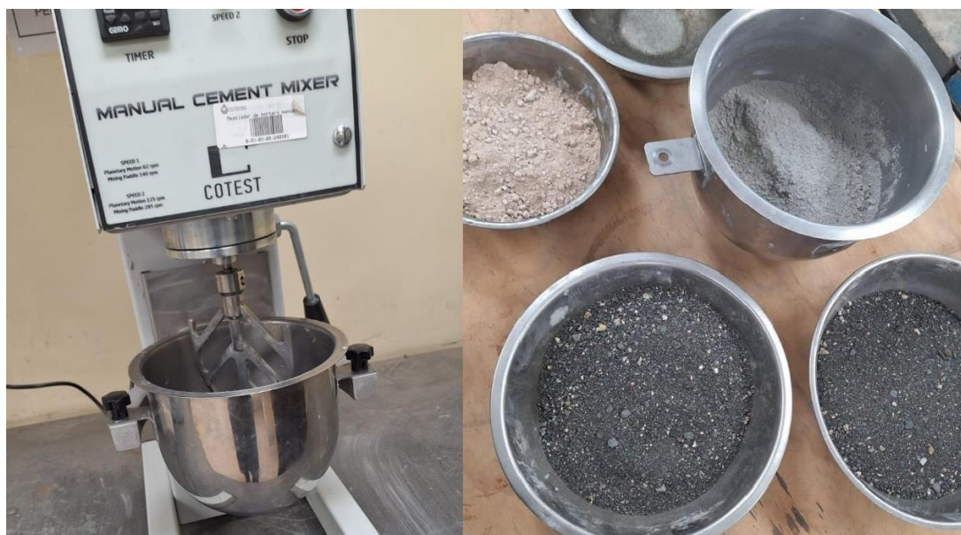
Figura 2: Materiales de la confección de mezcla y mezcladora utilizada
