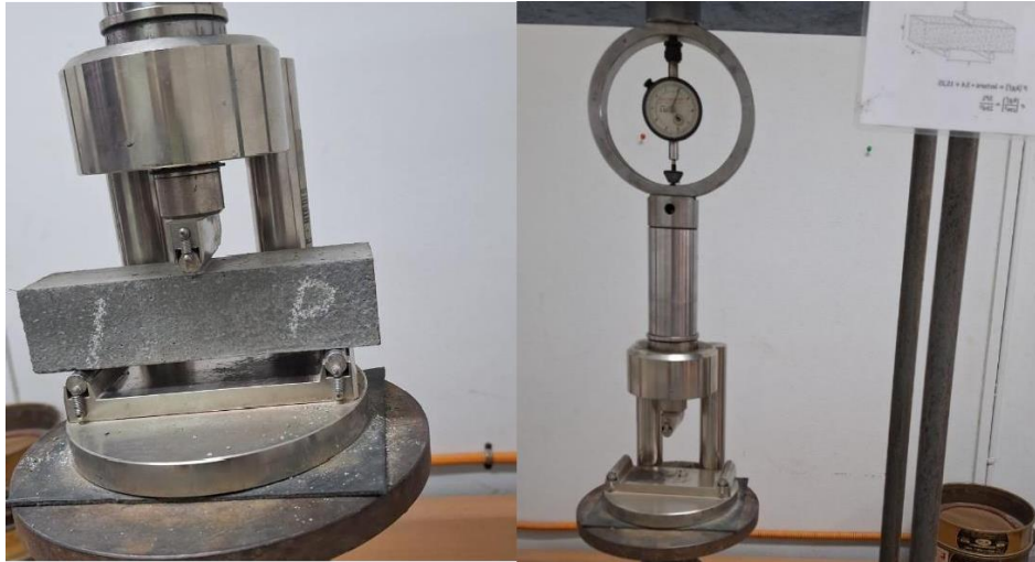
Figura 5: Maquinas utilizadas para los ensayos de resistencia a la flexión
