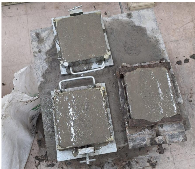
Figura 3: probetas de mrtero en la mesa vibradora para compactación
