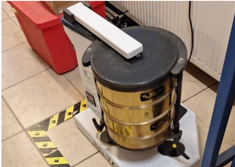
Figura 1: Tamizadora utilizada para el estudio de granulometria de la borra de salmuera
