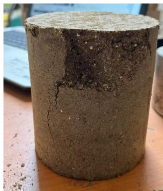
Figura 4.13 Falla de probeta de suelo Udec -cemento
