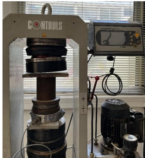
Figura 3.13 Prensa hidráulica para ensayo a compresión
