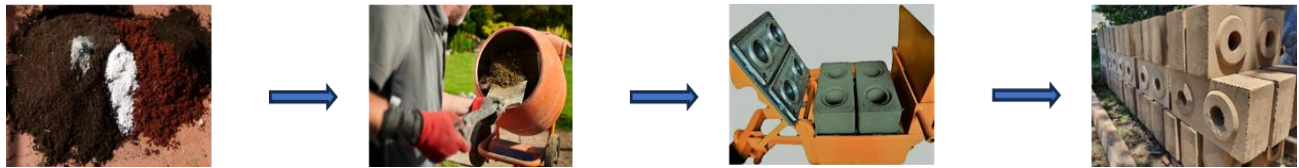
Figura 2.3 Proceso de confección de bloques de suelo comprimido
