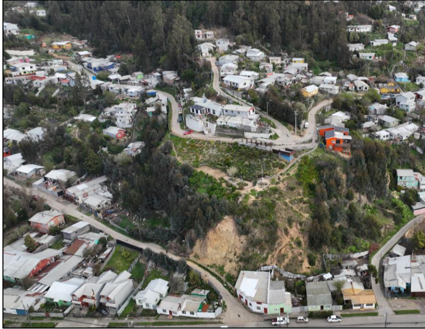
Fotografía 4.6: Vista aérea del Mirador Cerro La Cruz y Diagonal Freire afectado por RM. Tomada mediante dron.
