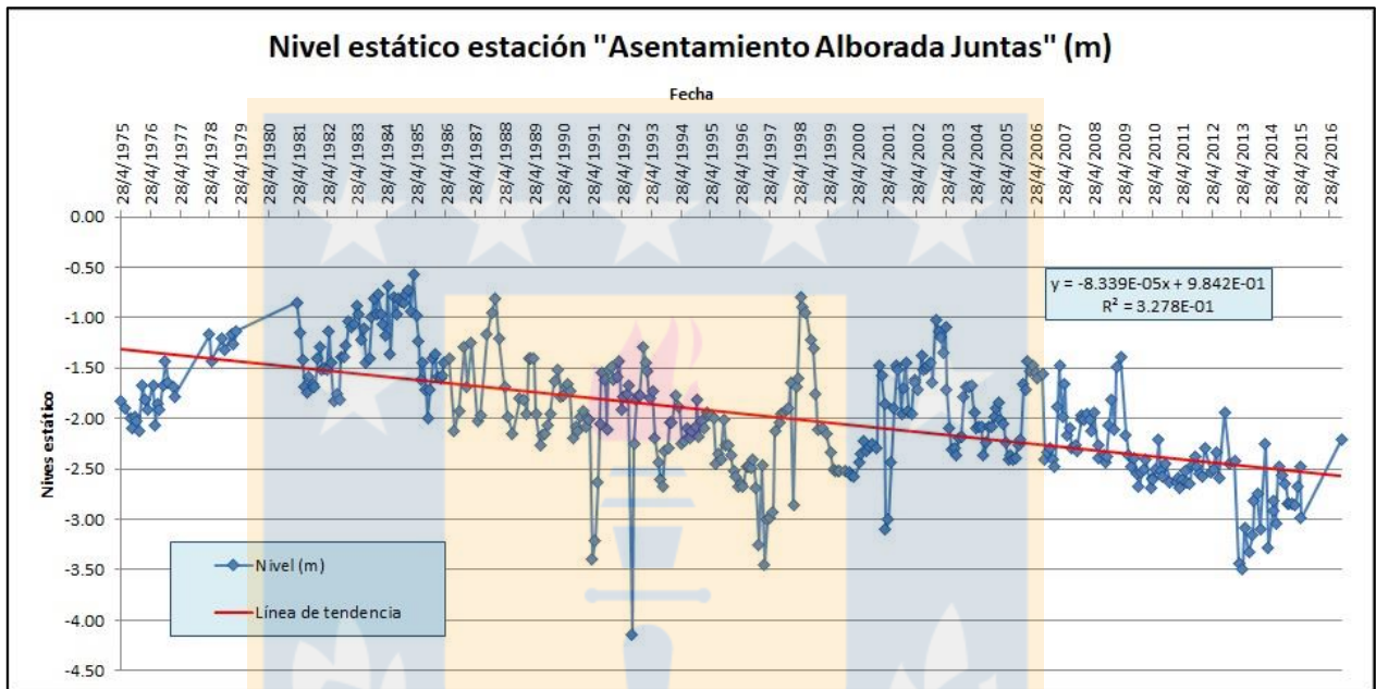
Figura 4.13. Gráfico con la tendencia de la profundidad del nivel piezométrico, entre 1975 y 2016. Elaboración propia.
