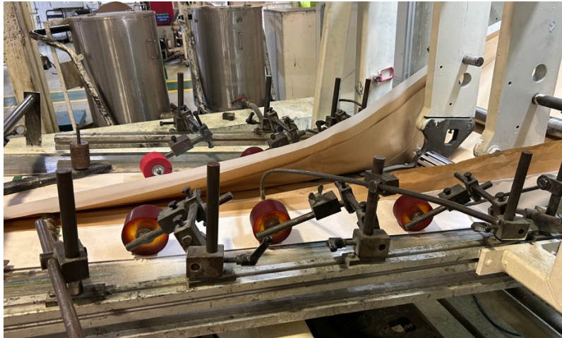
Figura 2.6: Encolado de tubos Fuente: Tubera Línea 5
