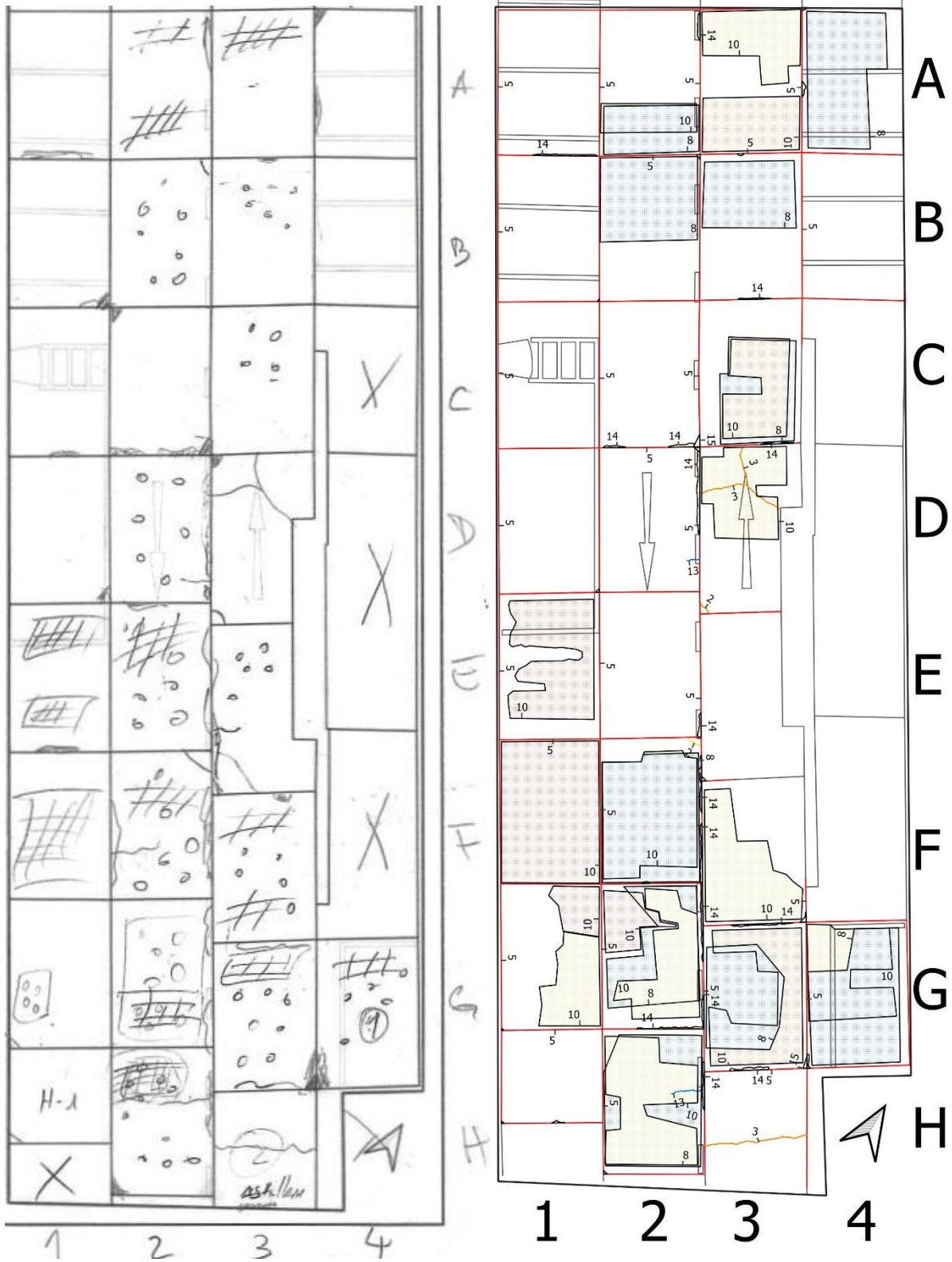
Figura 12: Croquis de ubicación de deterioros detectados en pavimento de hormigón con medición tradicional en terreno y mediante análisis fotogramétrico.
