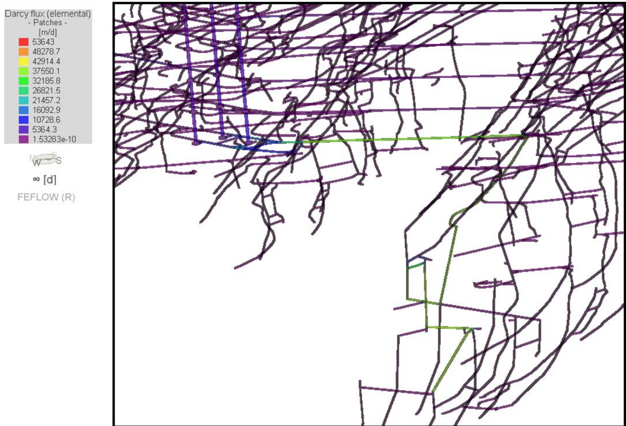
Figura 8.127 Flujo de Darcy (en elementos). Sección M2. Nótese que las altas velocidades coinciden con las direcciones preferenciales del flujo. Modelo 1-k 1 -B, régimen estacionario.
