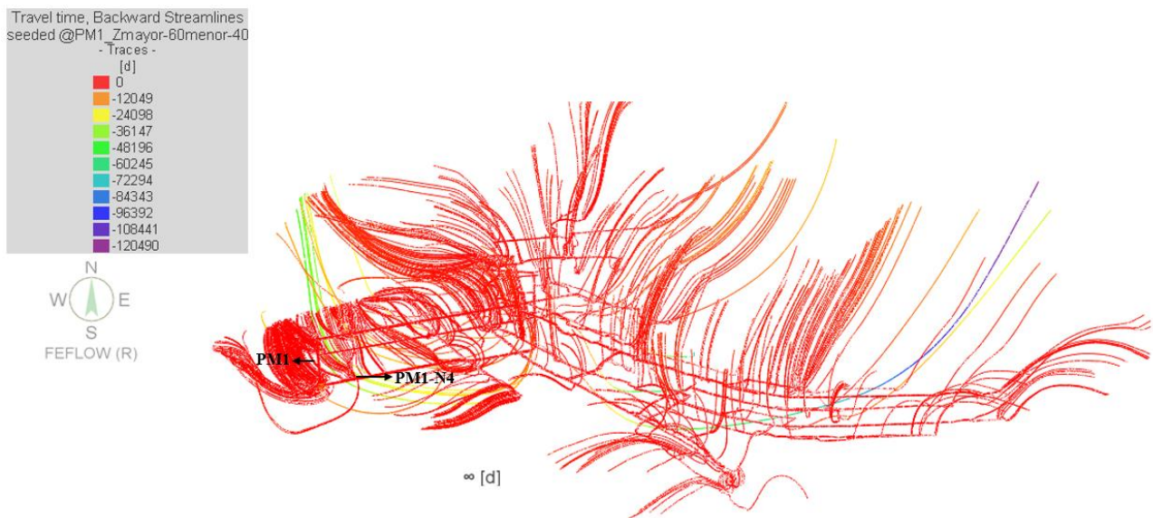
Figura 8.102 Líneas de flujo afluentes (backward) de PM1 (sección N4). Modelo 1-k 1 -B, régimen estacionario.
