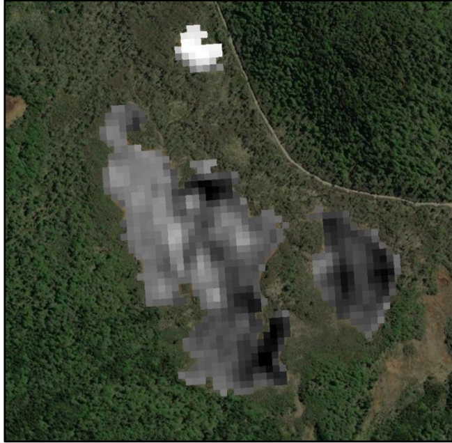
Figura 12. Área de estudio luego de aplicar herramienta “Extracción por máscara” para limitar el cálculo de carbono sólo a los píxeles correctos.
