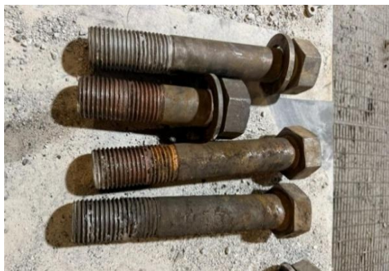
Figura 42: Pernos contaminados y corroídos por el efecto de la pulpa.
