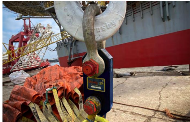
Figura 7: Monitoreo de carga en tiempo real en grilletes instrumentados [7].
