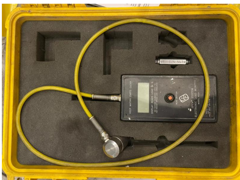
Anexo 12: Equipo de medición SPC4 con dispositivo de calibración.
