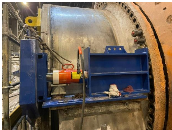
Anexo 23: Accionamiento del dispositivo de extracción del trunnion de descarga.
