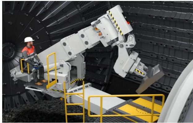
Figura 5: Sistema de recambio de revestimientos mediante brazos hidráulicos (MRM) [5].
