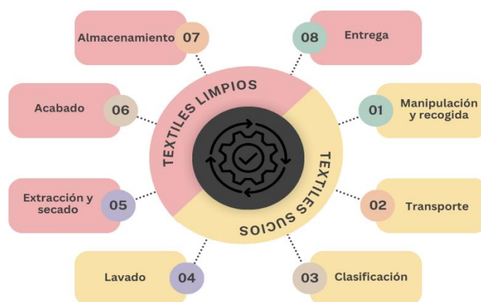
Figura 2-1: Ciclo ideal del proceso de lavandería de forma generalizada según los estándares de HLAC.
