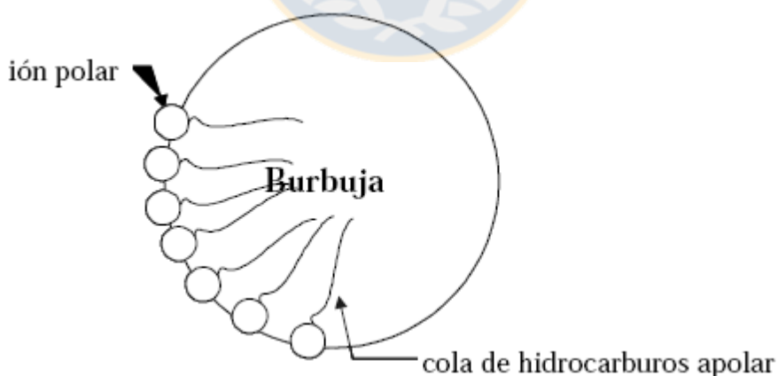
Figura 6: Representación adhesión del espumante a una burbuja de aire (Yianatos, 2005).
