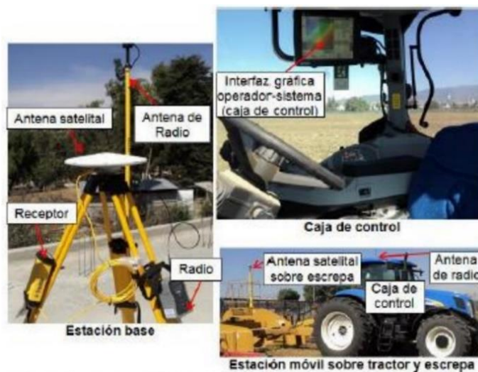
Figura 3. Estaciones base y móvil de un sistema de nivelación de tierras por GPS. Fuente: Prado y Hernández, 2014.
