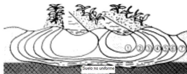
Figura 7. Forma del bulbo húmedo a diferentes minutos en un suelo no uniforme. Fuente: USDA, 1987.
