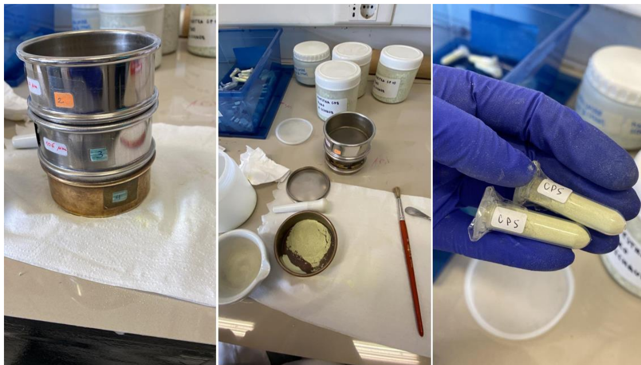
(a) Tamiz para tamaño de partícula entre 106 y 250 \mu\text{m} (b) Molienda de muestras en Laboratorio CarboCat (c) Muestra final molida y tamizada
