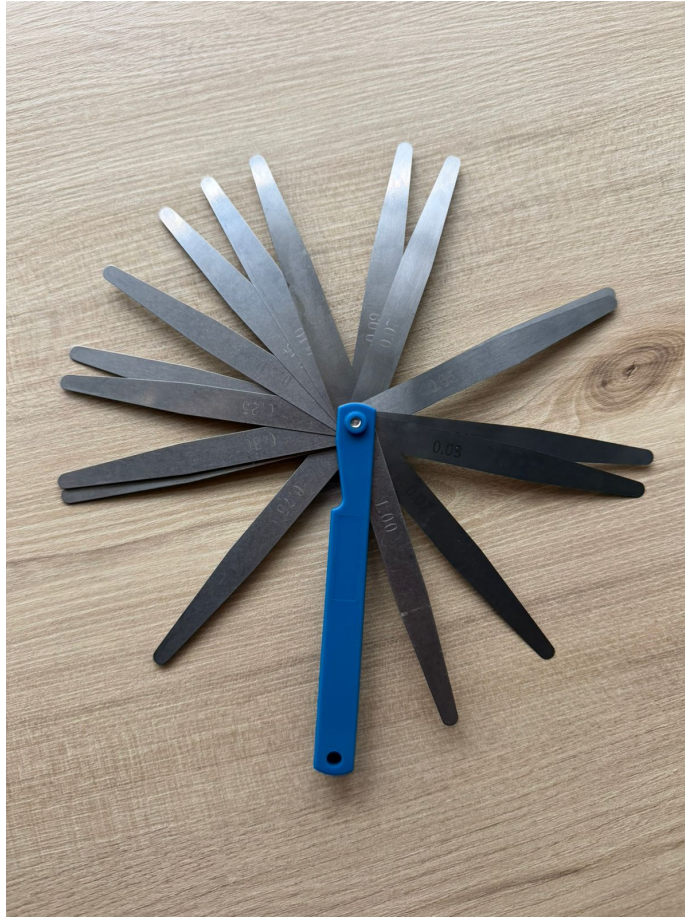
Figura 5.4 Juego de galgas de espesores utilizado para imponer condiciones de soldadura controlada en la unión apernada.
