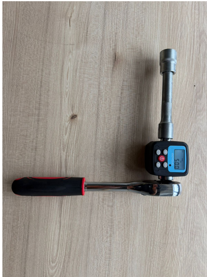
Figura 5.3 Medidor de torque digital acoplado a llave manual, utilizado para aplicar las condiciones de apriete en el banco de ensayos.
