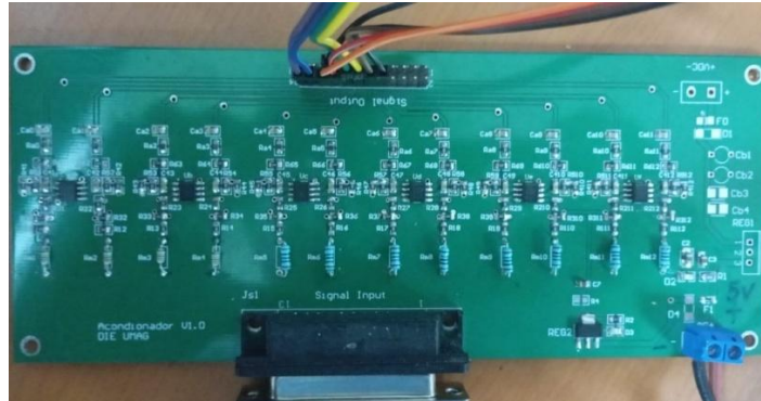
Fig. 3.3: Tarjeta de adaptación de señales medidas.
