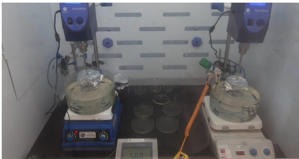
Figura A2-2: Montaje usado para la síntesis de las membranas.
