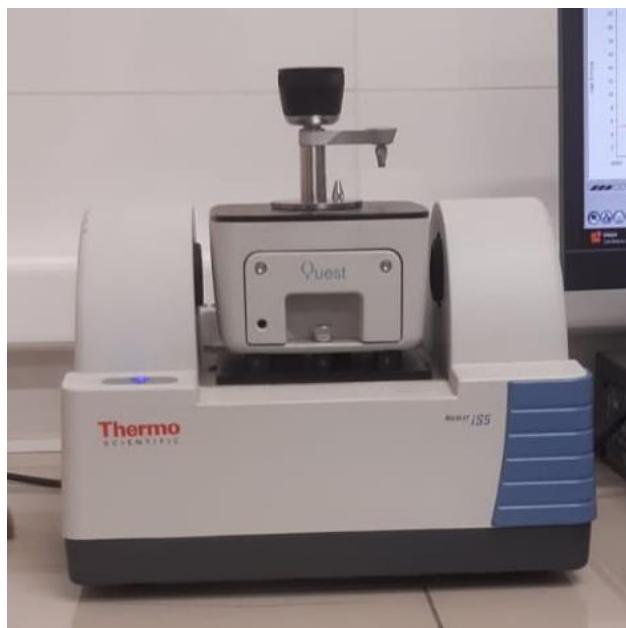
Figura 3-5: Espectrómetro de Thermo Fisher Scientific (Nicolet iS5, Estados Unidos).
