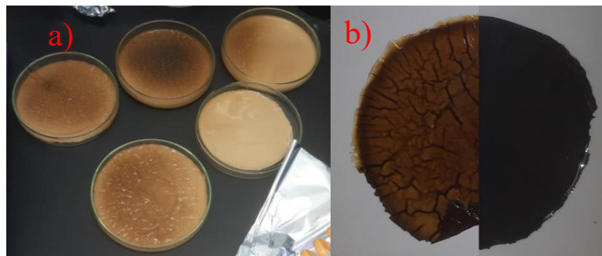
Figura 4-3: a) Membranas no reticuladas de la ejecución 9 luego del secado a 30°C por 16 horas. b) Comparación entre membrana no reticulada y membranas reticulada de la ejecución 9.
