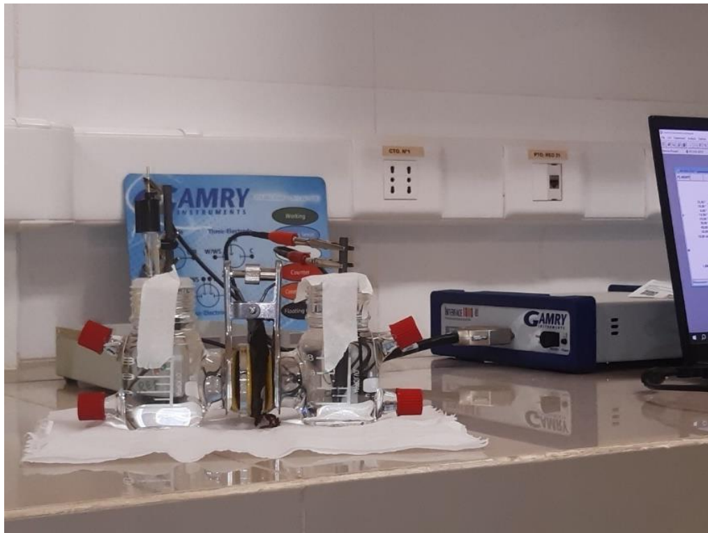
Figura A5-1: Montaje para de pruebas de conductividad protónica
