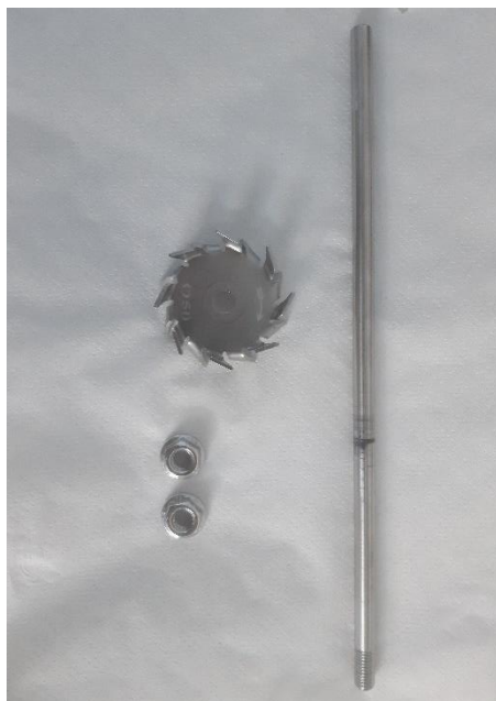
Figura A2-1: Agitador de aspas cowles empleado para la agitación.
