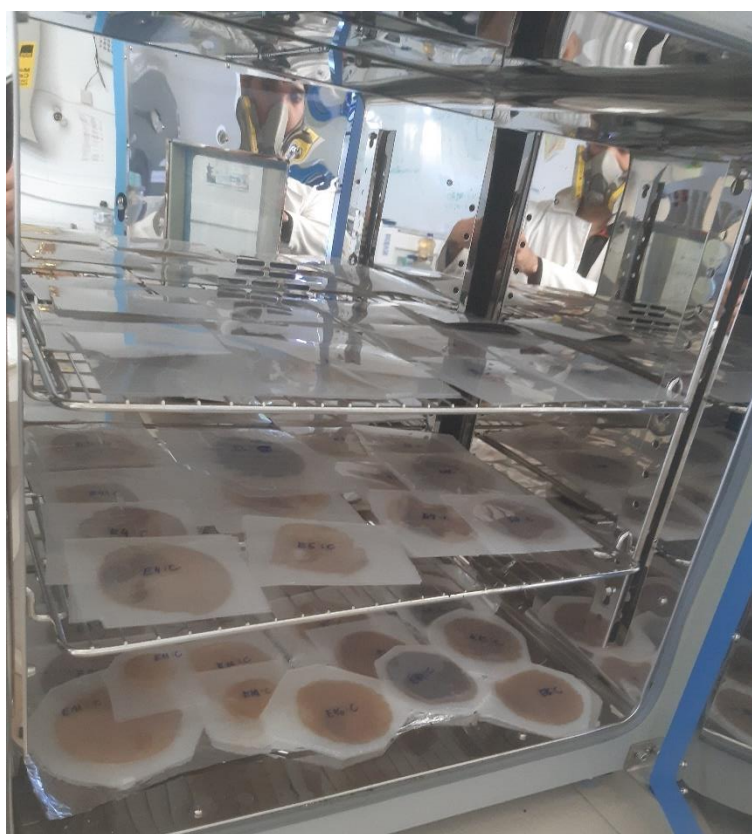
Figura A2-4: Secado de membranas intercaladas en láminas de termolaminado en horno de secado.
