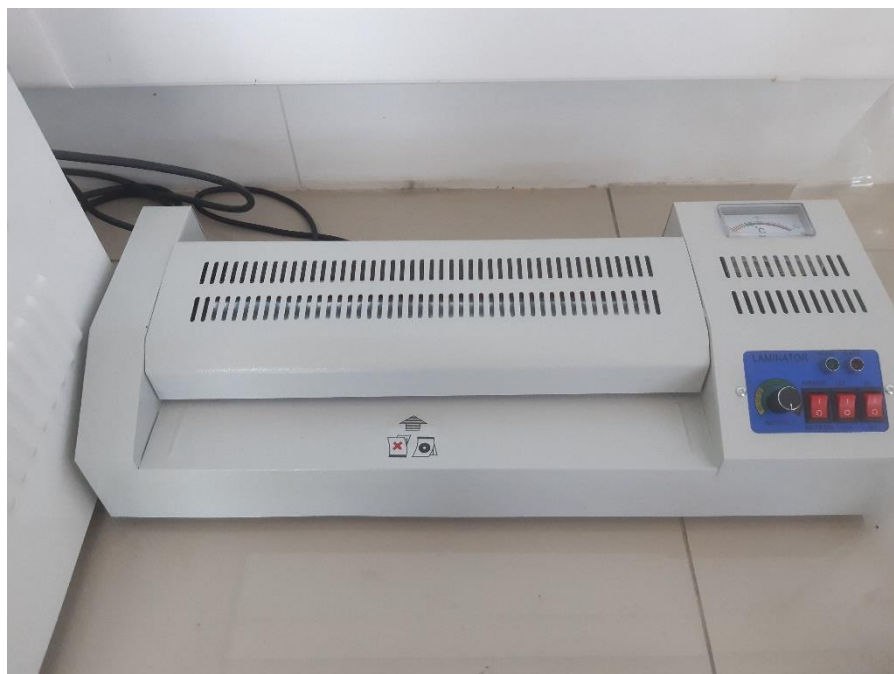
Figura A2-3: Termolaminadora usada para aplanar las membranas tras su remoción de las placas de Petri.
