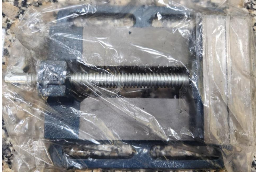
Figura H.3: Prensa plana comprada, para el sistema de cierre de la máquina inyectora.
