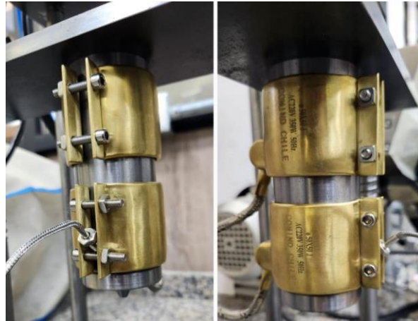
Figura 54: Ajuste de calefactores boquilla y termocupla en el cilindro de plastificación.
