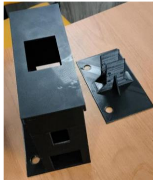
Figura 48: Caja de conexiones eléctricas y soporte de válvula de control impresas en PLA.
