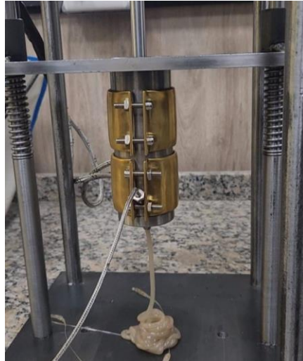
Figura 57: Prueba de inyección de PLA sin molde.
