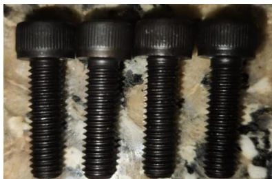
Figura B.1: Pernos de fijación del cilindro neumático.
