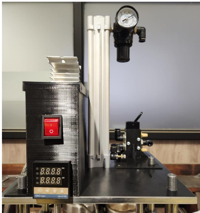
Figura H.4: Instalación de caja de conexiones eléctricas y soporte con válvula de control de flujo de aire.
