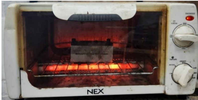
Figura 62: Pre calentamiento del molde en un horno a 240 °C.
