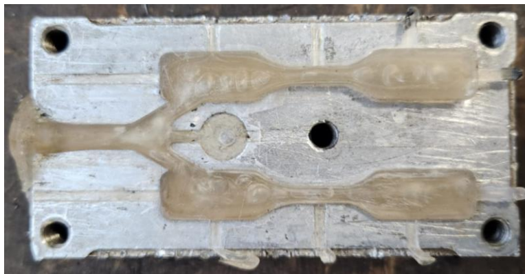
Figura 63: Probetas moldeadas con presencia de burbujas.
