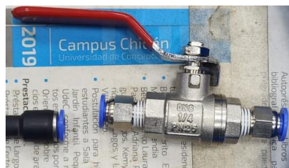
Figura 39: Válvula de bola seleccionada.
