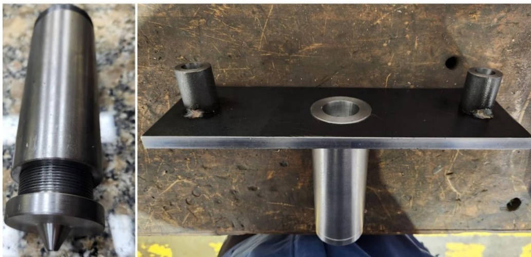
Figura G.2: Ensamblaje de boquilla de inyección, cilindro de plastificación, y placa de fijación.
