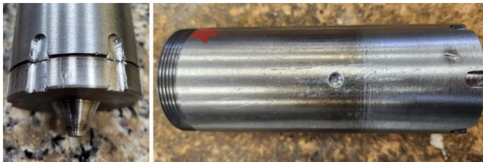
Figura 60: Modificaciones realizadas a la boquilla y el cilindro de plastificación.
