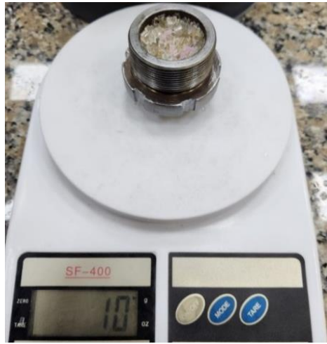
Figura 61: Cantidad mínima de material que la máquina puede inyectar.
