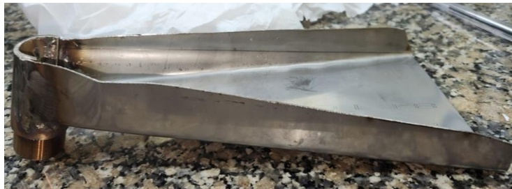
Figura 47: Tolva de alimentación de acero AISI 1020.
