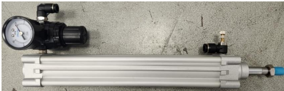
Figura 8: Cilindro neumático de doble efecto seleccionado.
