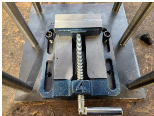
Figura 55: Ajuste de la prensa plana en la placa base.
