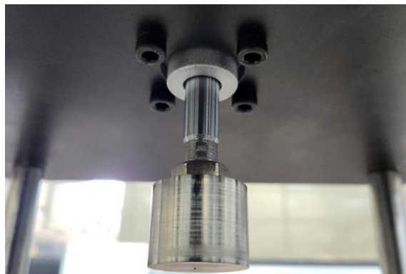
Figura 51: Ajuste del émbolo de inyección en vástago del cilindro neumático.
