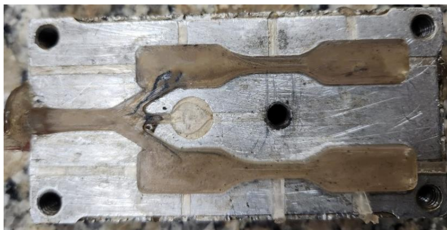
Figura 64: Probetas moldeadas casi sin presencia de burbujas.
