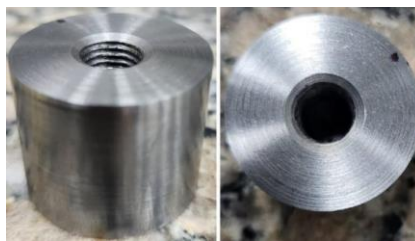
Figura 44: Émbolo de inyección de acero AISI 1045.
