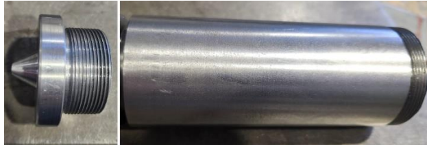
Figura 43: Boquilla de inyección y cilindro de plastificación de acero AISI 1045.
