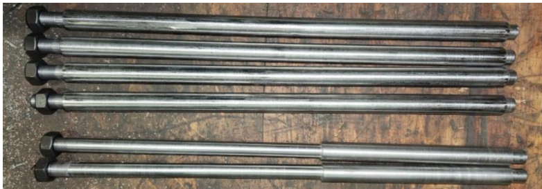
Figura 42: Columnas de soporte de acero ASTM A36.
