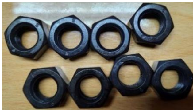
Figura E.1: Tuercas hexagonales para ajuste de placa superior a columnas.
