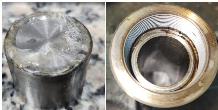
Figura 58: PLA solidificado en el émbolo de inyección y filtración de PLA en unión roscada.
