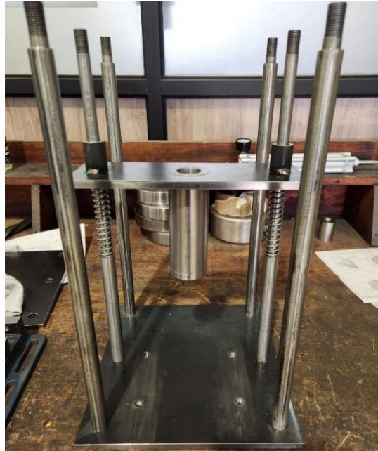
Figura G.3: Ajuste del ensamblaje de la placa con el cilindro de plastificación sobre los resortes de compresión.
