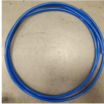
Figura 40: Manguera neumática de 8 mm de poliuretano.
