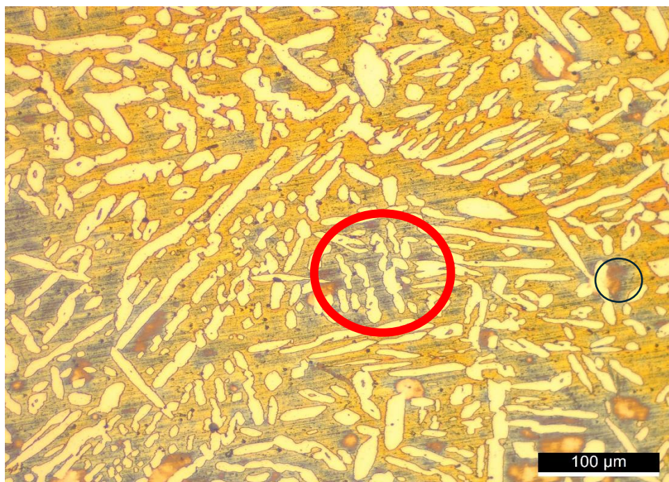
Figura 10 Microscopía óptica de la muestra T2 de acero inoxidable dúplex(Elaboración propia).
