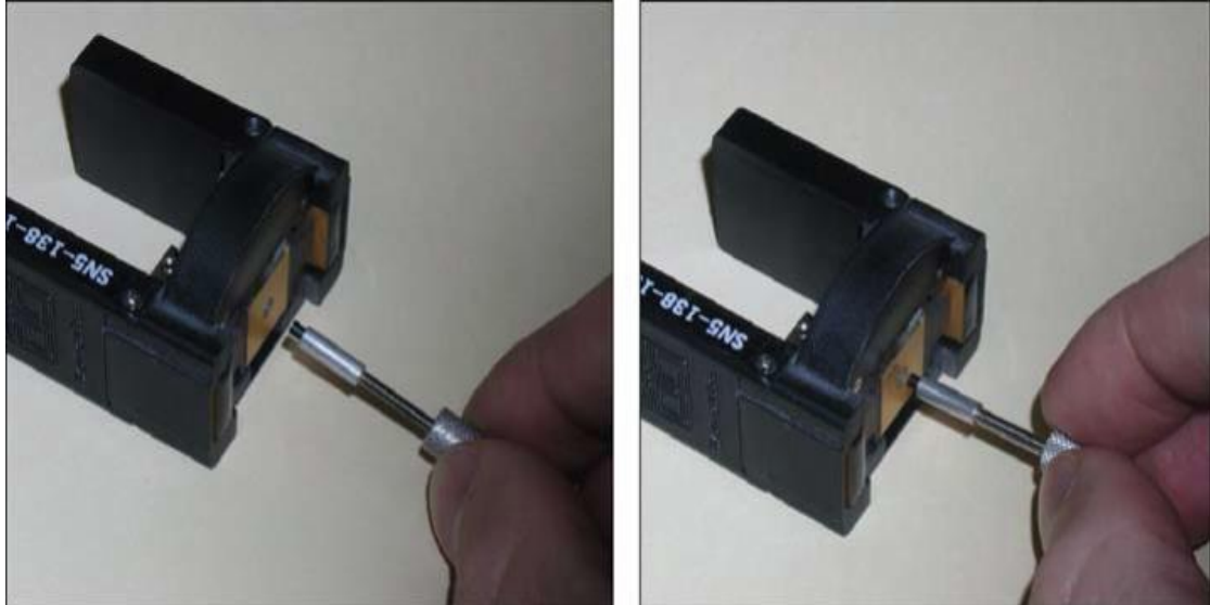
Figura A 13 Instalación de la sonda en el piezo escáner sin EPPS (Hysitron, Inc, 2014).
