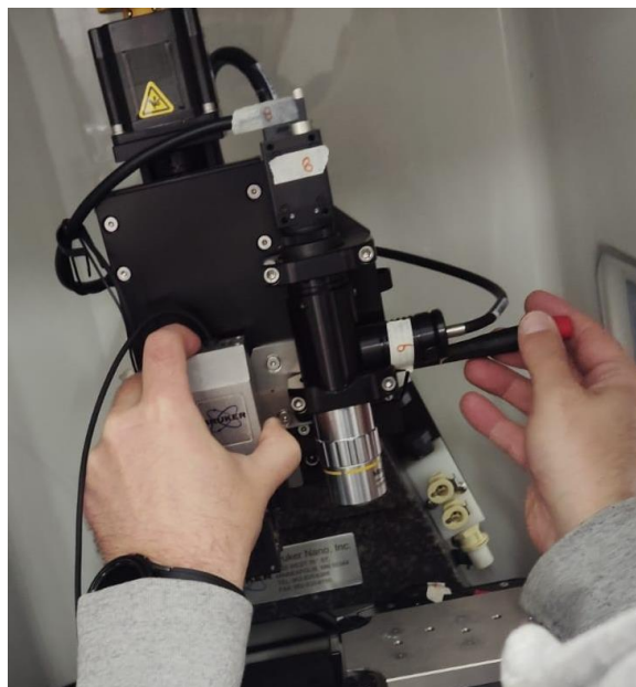
Figura A 7 Proceso de desmontaje del complejo transductor- piezo- sonda (Elaboración propia).
