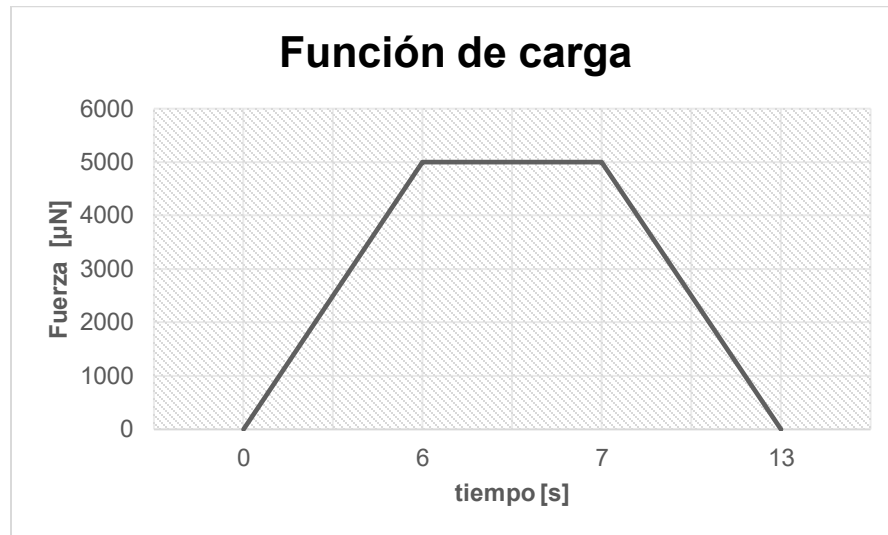
Figura 8 Función de carga aplicada a la muestra basada en la evidencia bibliográfica y experiencias previas (Elaboración propia).
