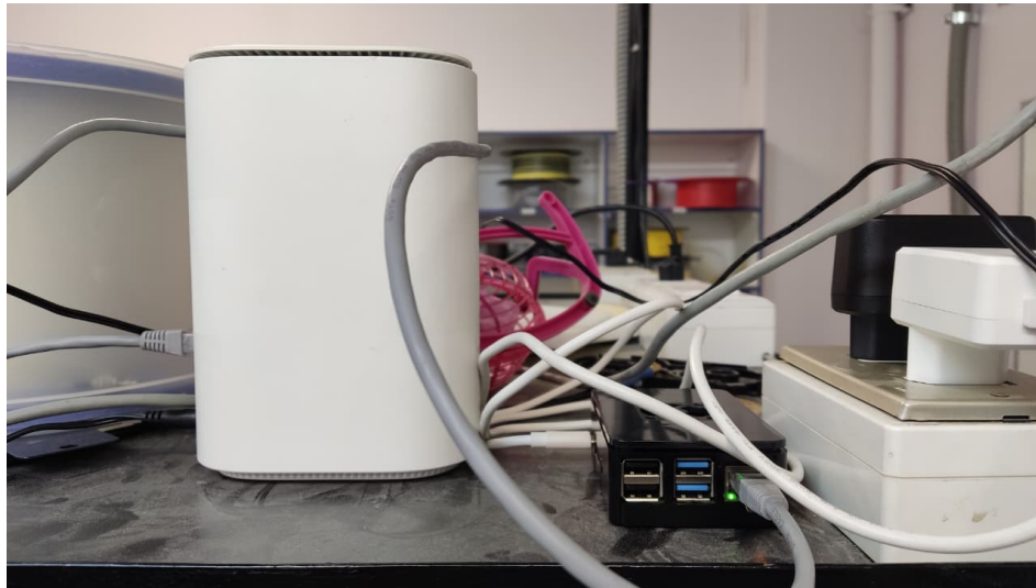
Fig. 3.6: Dispositivo fijo instalado para la medición de velocidades objetivo al servidor UdeC Nacional.
