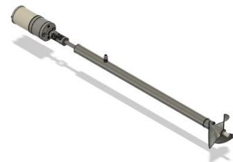
Figura 3.17: Isométrico de sistema de propulsión
