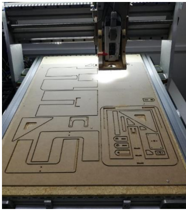
Figura 4.1: Mecanizado de piezas del BSPC
