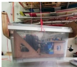
Figura 4.13: Banco de ensayo colgando de su centro de gravedad en el eje X
