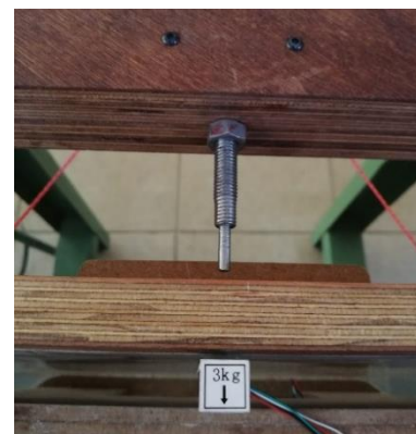
Figura 4.9: Celda en soporte lateral y perno de carga
