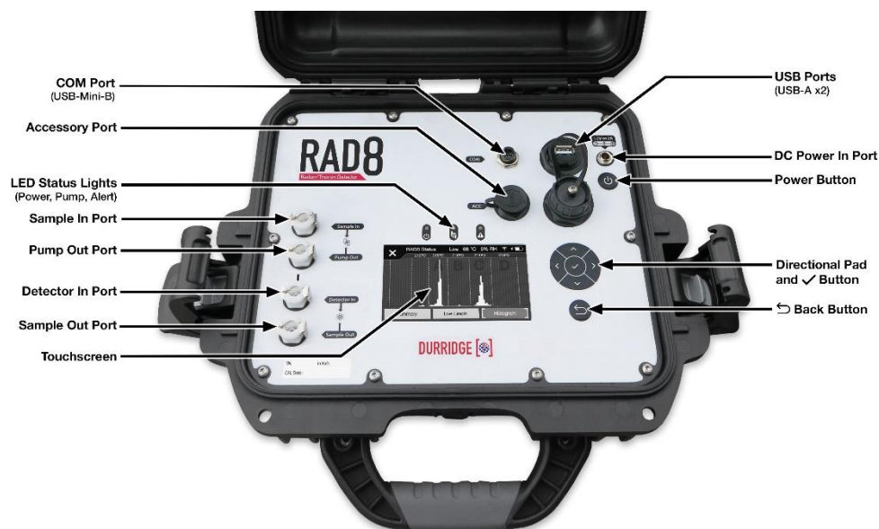
Figura 4. Diagrama del detector de radón RAD8 (DurrIDGE Company, 2023).
