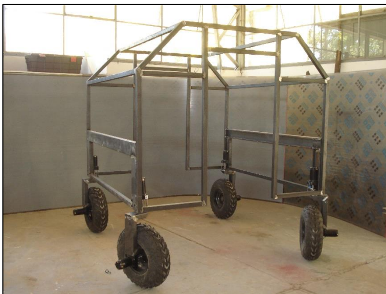
Figura 3. Estructura del Robot BACO. Fuente propia.
