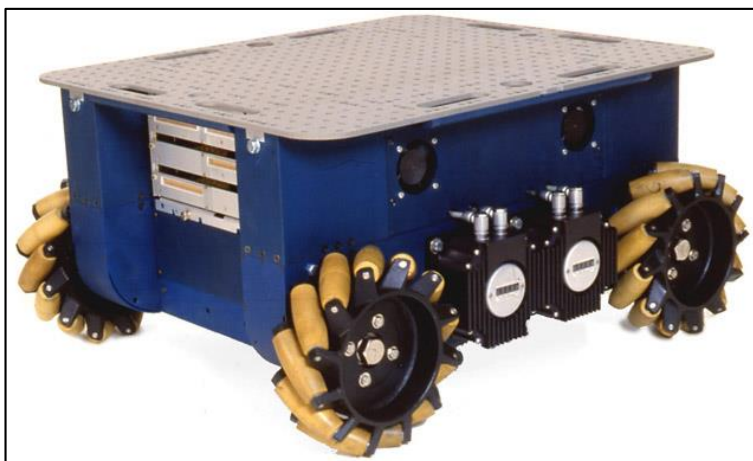
Figura 1. Robot omnidireccional Uranus, dotado con ruedas suecas. Muir y Neuman (1987).
