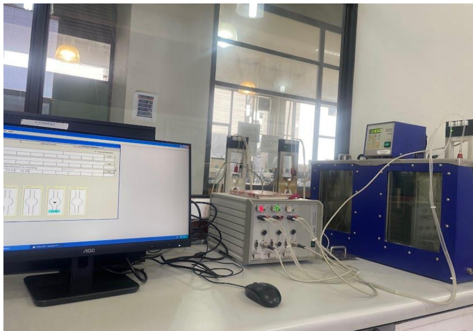
Figura 20. Viscosímetro capilar Cannon-Fenske 200 con fototemporización y procesamiento PVS1 interconectado a un computador.
