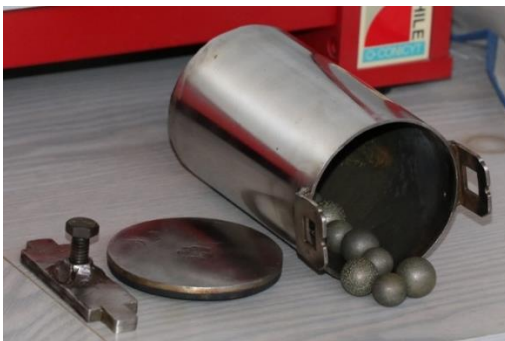
Figura 24. Molino de bolas para molienda húmeda de calcopirita, bornita y enargita.
